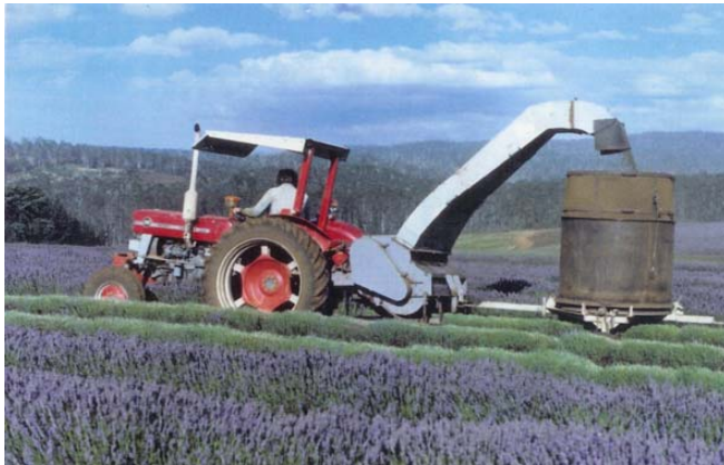
Fig. 4. Colheita mecânica de lavanda directamente para contentor de destilação (Denny 1991).
