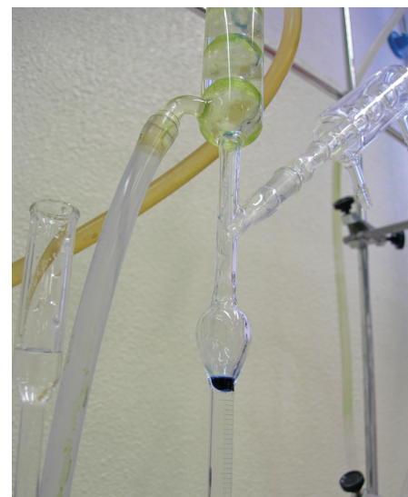
Figura 4 Pormenor da ampola de recolha do óleo essencial do aparelho de Clevenger. Na fase superior, o óleo essencial de tonalidade azul, e, na fase inferior, o hidrolato transparente.
